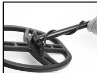
5. Вставьте штекер кабеля в разъем корпуса металлодетектора и надежно затяните его вручную.
