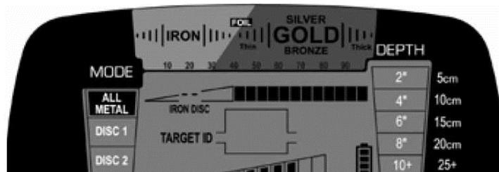
«Все металлы» - Этот режим позволяет Вам вести поиск без дискриминации. Прибор дает звуковой сигнал на любой металлический объект, попавший в зону действия катушки. Включены все 12 сегментов шкалы дискриминации, а опция Iron Discrimination (дискриминация железа с высоким разрешением) отключена (--), что указывает на то, что из обнаружения не исключается ни один тип металла.
