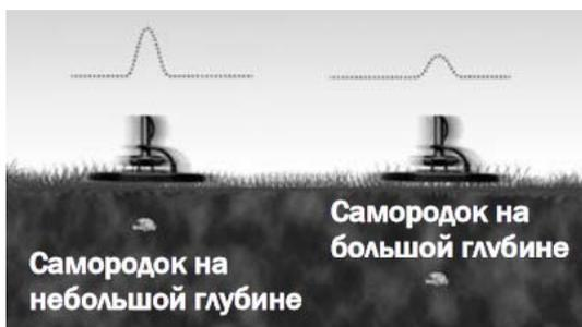
**Пример В:** Обратите внимание на разницу в откликах *AT Gold* с пропорциональным откликом, зависящим от глубины объекта. Для объектов на малой глубине звуковой сигнал сильнее, а такой же объект на большей глубине дает более тихий отклик.
