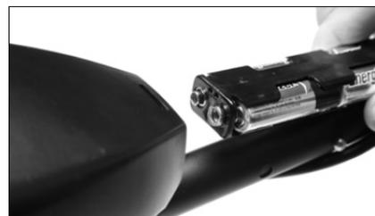
Чтобы открыть батарейный отсек поверните крышку отсека на 90° против часовой стрелки и потяните на себя.
