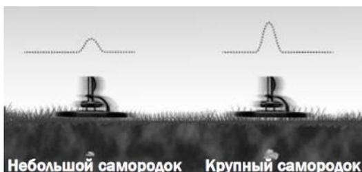
**Пример С:** Обратите внимание на разницу в откликах *AT Gold* с пропорциональным откликом, зависящим от размера объекта. Небольшой самородок сопровождается тихим сигналом, а крупный самородок, лежащий на той же глубине, дает более громкий сигнал. Размер объекта можно оценить, приподняв катушку и поведя ею над объектом. Крупные объекты продолжают регистрироваться на большем расстоянии от катушки, сигнал от мелких очень быстро теряется.
